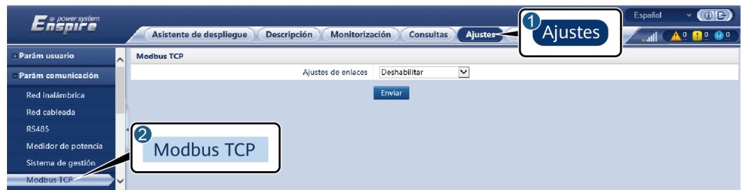
Figura 6-36 Configuración de los parámetros de Modbus TCP
