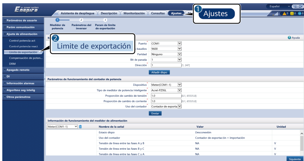
Figura 6-76 Configuración de los parámetros de limitación de exportación
