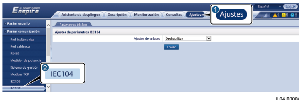
Figura 6-33 Configuración de los parámetros de IEC104
