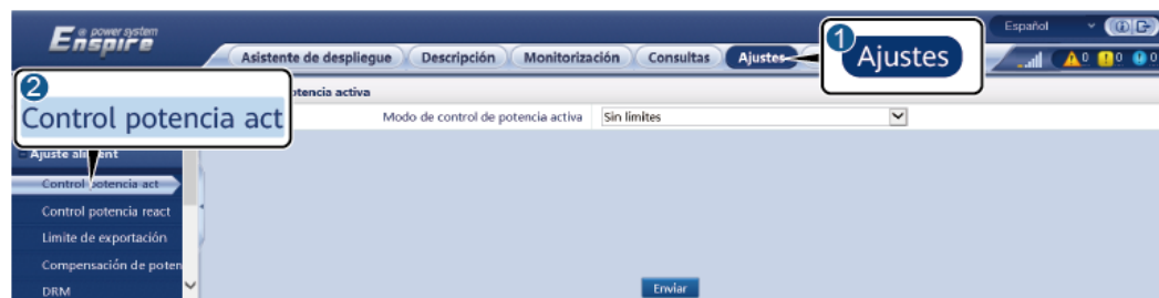
Figura 6-71 Control de potencia activa
