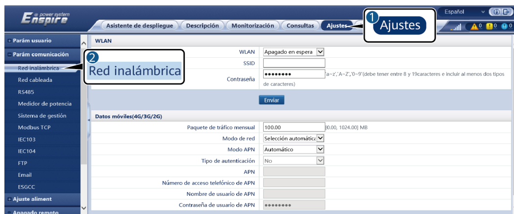
Figura 6-28 Configuración de parámetros de datos móviles
