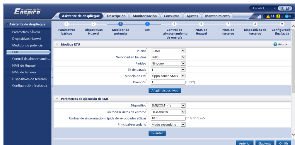
Figura 6-10 Configuración de los parámetros del EMI
