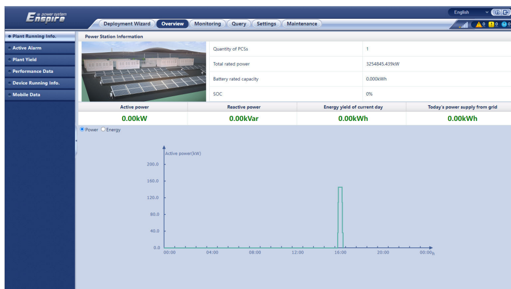
Figura 6-4 Información de funcionamiento de una planta (con batería, pero sin medidor de potencia)
