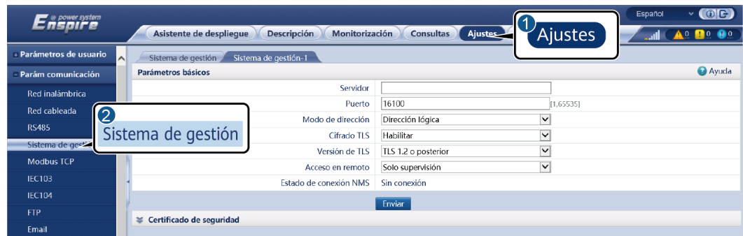
Figura 6-31 Configuración de los parámetros del sistema de gestión 1
