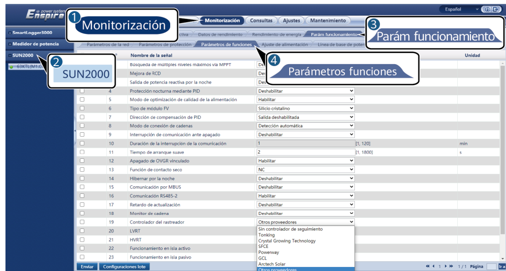
Figura 6-48 Configuración del controlador del sistema de seguimiento
