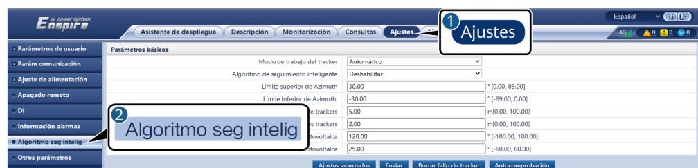
Figura 6-66 Parámetros del algoritmo de seguimiento inteligente
