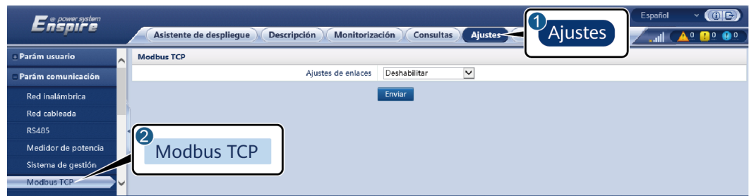
Figura 6-39 Configuración de los parámetros de Modbus TCP
