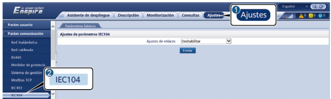
Figura 6-37 Configuración de los parámetros de IEC104
