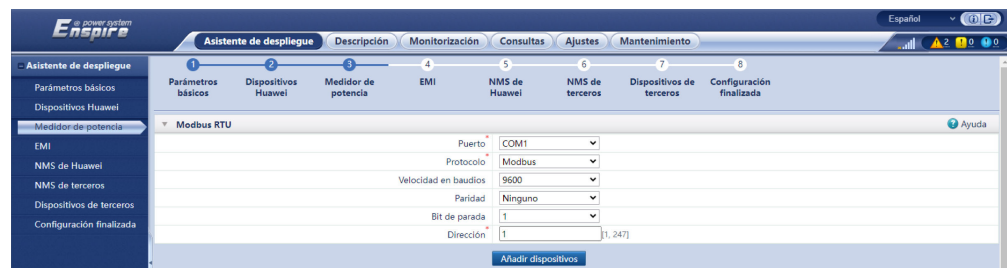
Figura 6-9 Configuración de los parámetros del contador de potencia
