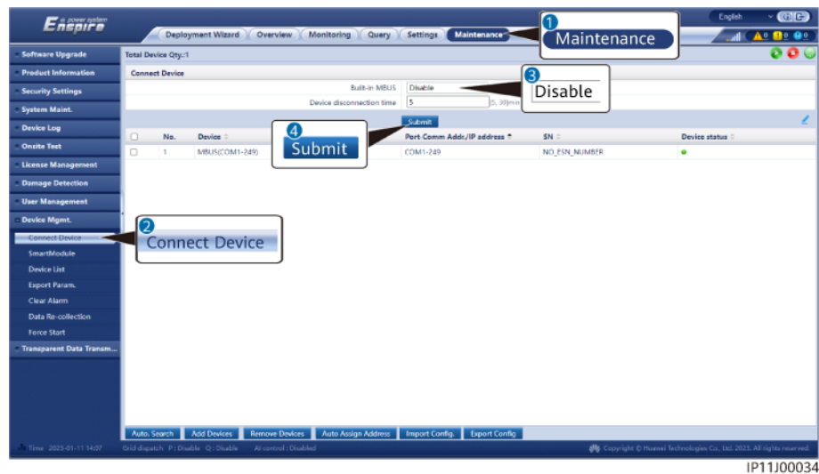
Figura 6-45 Configuración de parámetros del módulo MBUS integrado
