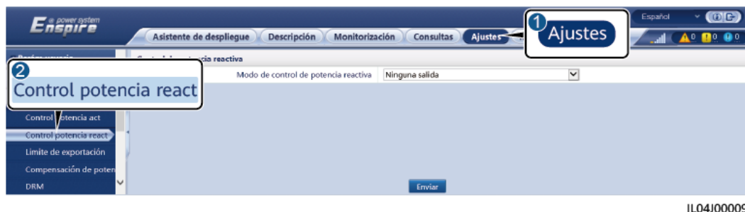
Figura 6-72 Control de potencia reactiva
