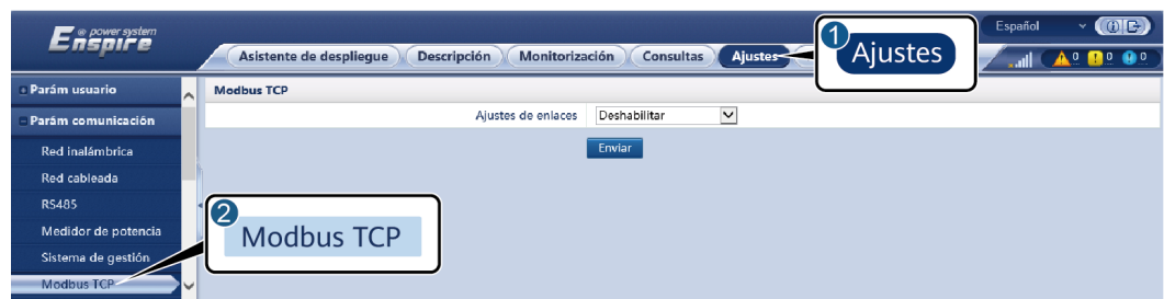
Figura 6-32 Configuración de los parámetros de Modbus TCP
